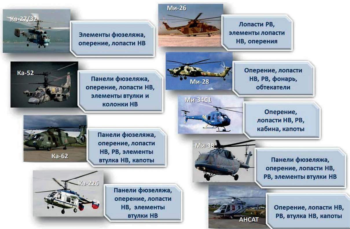
Рисунок 8. Узлы и детали из ПКМ модельного ряда вертолетов
