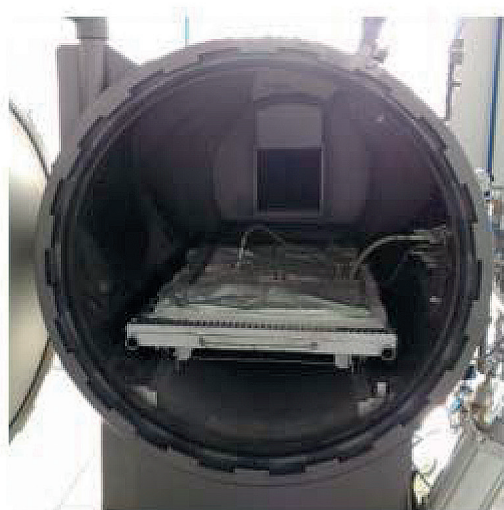
Рисунок 2. Автоклавное формование препрега
