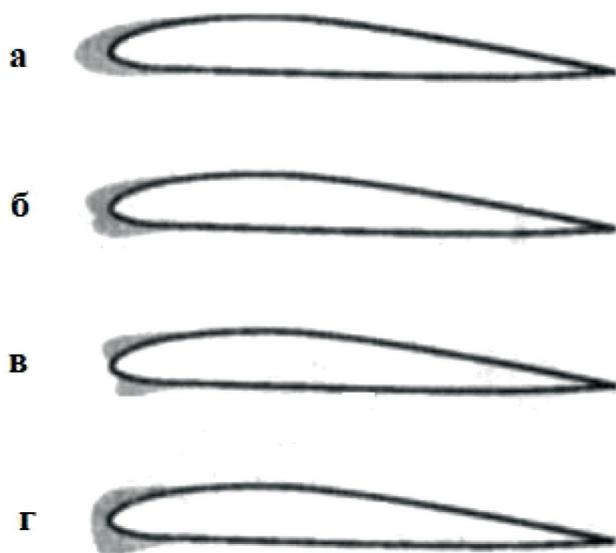
Рисунок 1. Формы льдообразований на лобовых поверхностях: а – клинообразная; б – желобообразная (корытообразная); в – рогообразная; г – промежуточная
