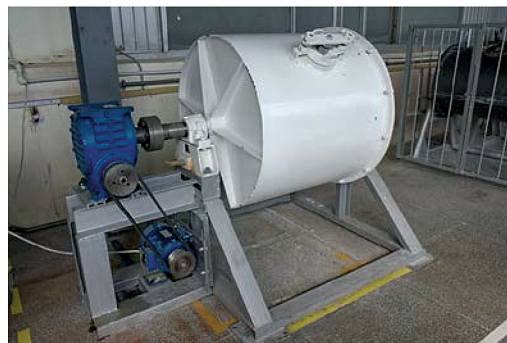
Рисунок 2. Изображение мельницы для получения водного шликера со схемой механического привода: 1 – металлический корпус мельницы, 2 – гипсовый слой, фиксирующий керамическую футеровку в металлическом корпусе, 3 – керамическая футеровка, 4 – мелящие тела, 5 – шликер, 6 – муфта соединительная, 7 – редуктор, 8 – ременная передача, М – электродвигатель
