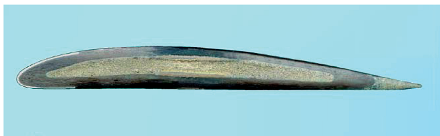
Рисунок 5. Конструкция углепластиковой лопасти 720 (РВ) вертолета Ка-60 (а) и характерное сечение лопасти (б)
