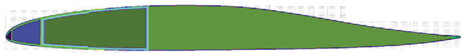
Рисунок 7. Типовое сечение лопасти НВ из гибридного ПКМ на основе стеклянного и угольного волокна
