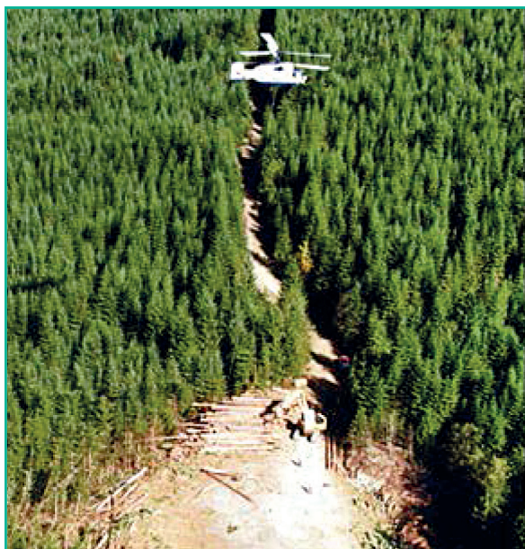
Рисунок 4. Транспортировка леса на внешней подвеске с труднодоступных мест
