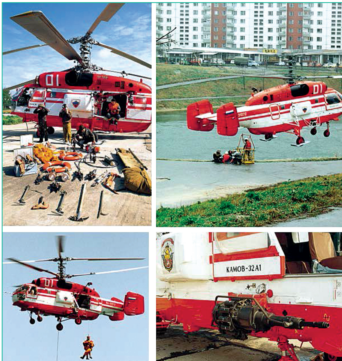
Рисунок 8. Применение вертолетов типа Ка-32 при подготовке к тушению пожаров и выполнению аварийно-спасательных работ
