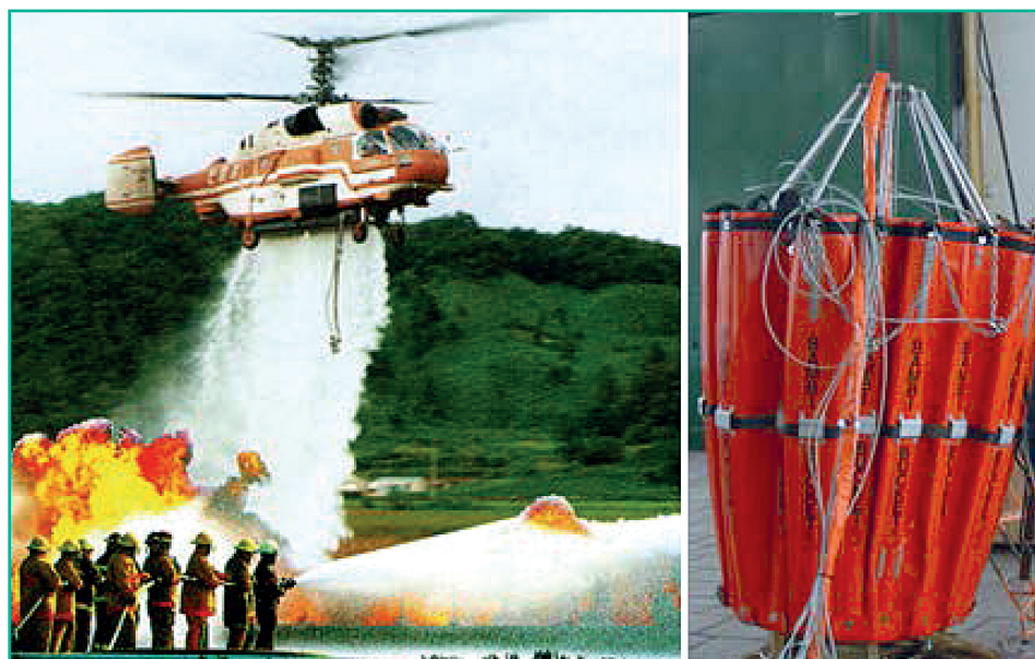
Рисунок 9. Работа вертолета Ка-32А11ВС: а) в зоне пожара; б) система Bambi-Bucket
