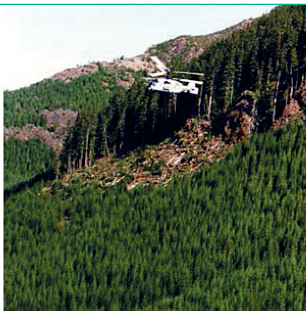
Рисунок 4. Транспортировка леса на внешней подвеске с труднодоступных мест
