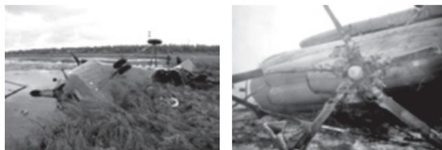
**Рис. 14. Разрушение вертолета при посадке**
