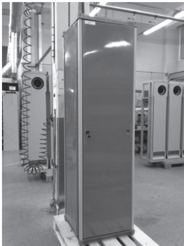
Рис. Базовая несущая конструкция из композитных материалов
