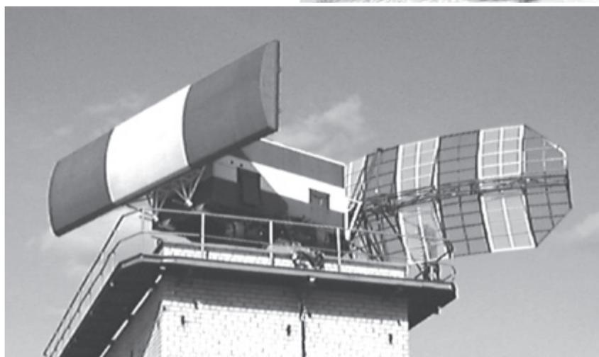
**Рис. 2. Параболическая антенна в составе РЛС**
