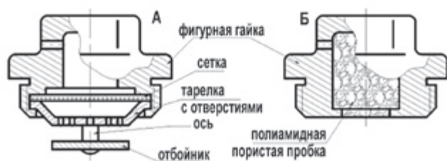
Рис. 5. Конструкция крышки до (А) и после (Б) анализа качества изделия
