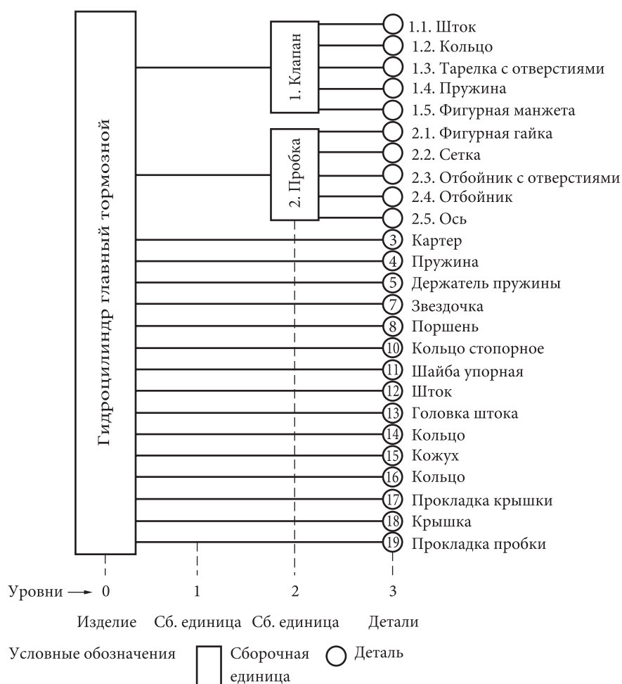
Рис. 4. Структура устройства гидроцилиндра в виде «дерева связей»
