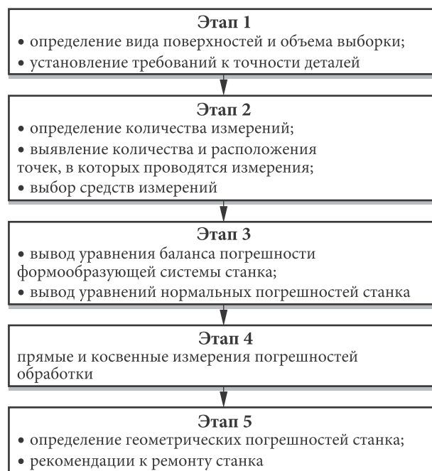
Рис. 1. Схема функциональной диагностики МРС [5]
