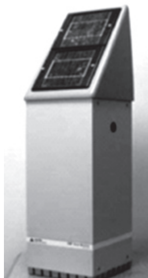
Рис. 2. Автономный измерительный комплекс для мониторинга ЭМО вблизи БС сотовой связи [6]
