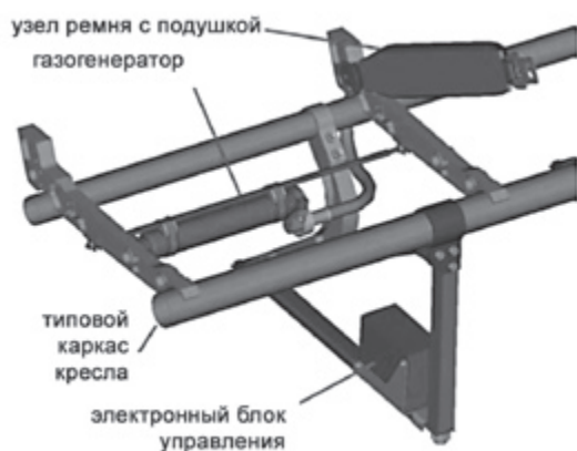
Рис. 4. Типовая схема установки системы AIRBAG на конструкции авиационного пассажирского кресла
