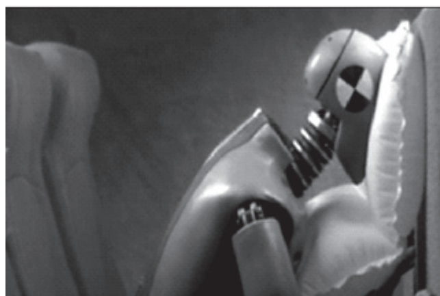
Рис. 2. Момент удара головы манекена о наполненную подушку системы AIRBAG на перегородке салона
