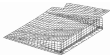
Рис. 2. Деформированное состояние дефлектора изд. Бе-200 от клеточной нагрузки воды, приложенной в его центральной части
