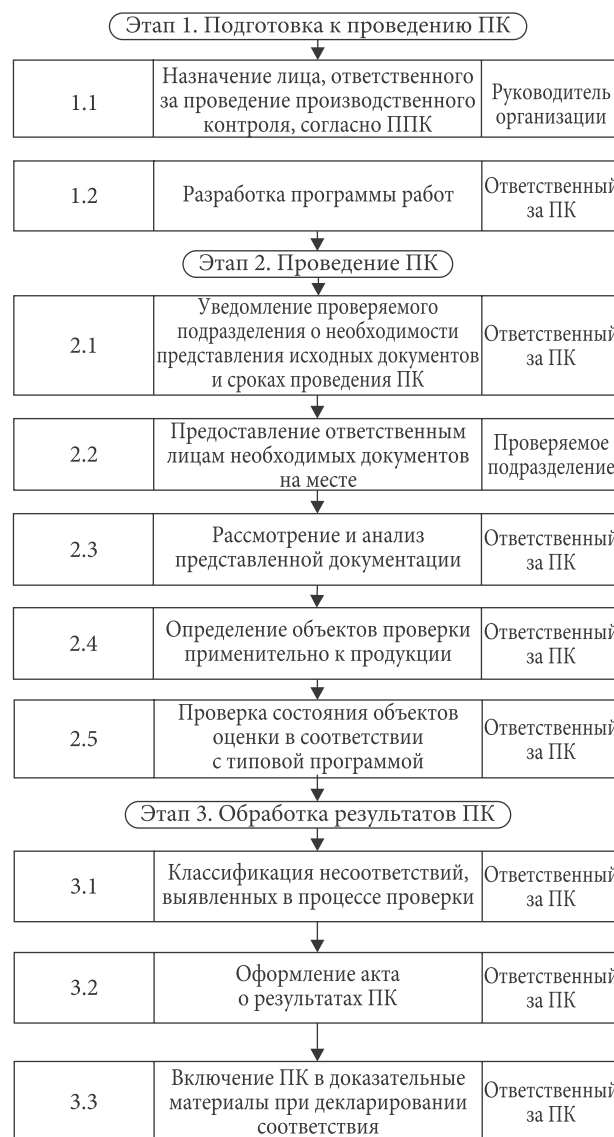
Рис. 2. Порядок проведения ПК при декларировании соответствия
