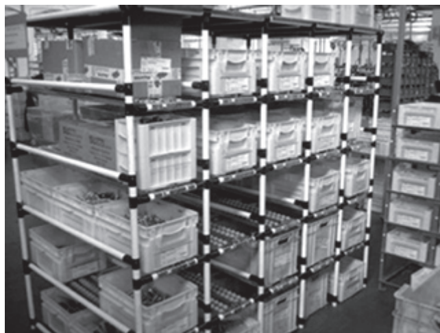
Рис. 4. Супермаркет – место хранения готовых деталей заранее установленной номенклатуры
