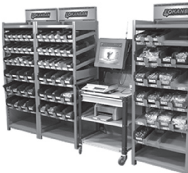
Рис. 5. Рабочее место, откуда происходит обращение к супермаркету при помощи карточек канбан
