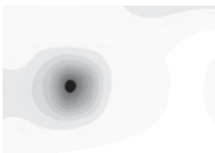
Рис. 3. Восстановленная область амплитуд для второй собственной формы консольной пластины без дефектов
