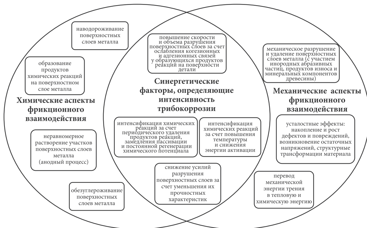
Рис. 1. Факторы, определяющие механизм и интенсивность протекания коррозионно-механического изнашивания в древесно-металлических узлах трения
